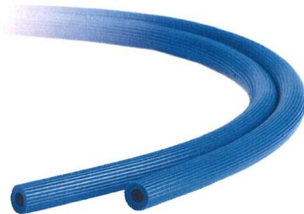
Bei der Injektion gelangt der Injektionsstoff über schmale Schlitze im Schlauchmantel in die abzudichtende Fuge. Anordnung und Formgebung der Schlitze verhindern das Eindringen von Zementschlämme in den Injektionskanal.
