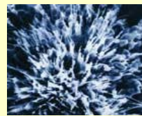
Beton mit Xypex
