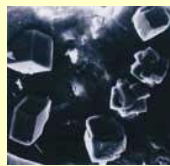
Beton ohne Xypex
