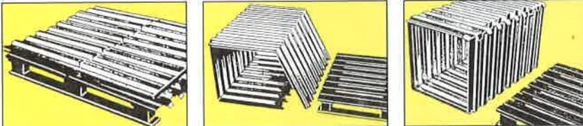
Der Faltköcher ist in 1 Minute montiert. Die übergreifenden Laschen werden von Hand einfach umgebogen. Es ist kein Werkzeug erforderlich. Der Faltköcher besitzt die gleiche Stabilität wie ein verschweißter Fertigköcher.
